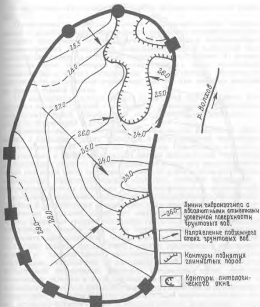
Рис. 1. Схема гидроизогипс уровня грунтовых вод на территории Новгородского кремля. Весна (май) 1994 г.
